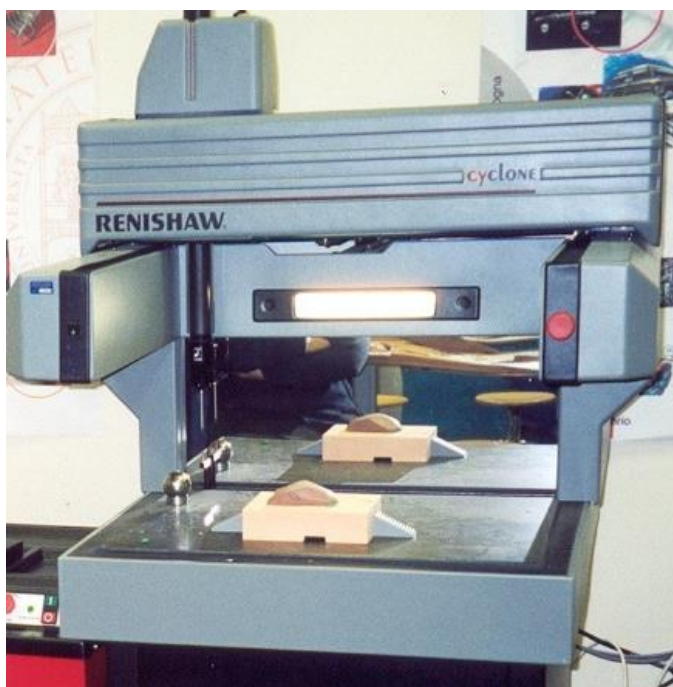
3D digitalizacija na “Renishaw Cyclon”
